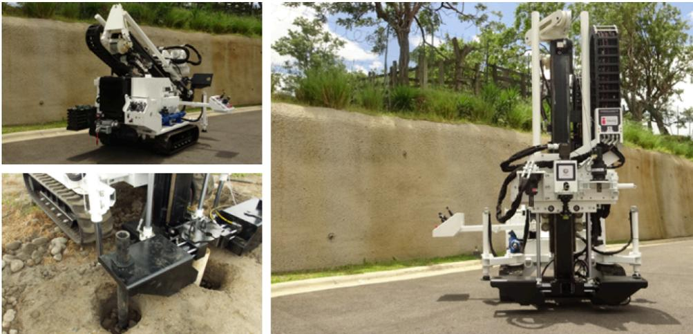
*Maquina de perforación Crossover 183 (Combinación de SPT, CPT, perforación con barreno y saca núcleos)*
